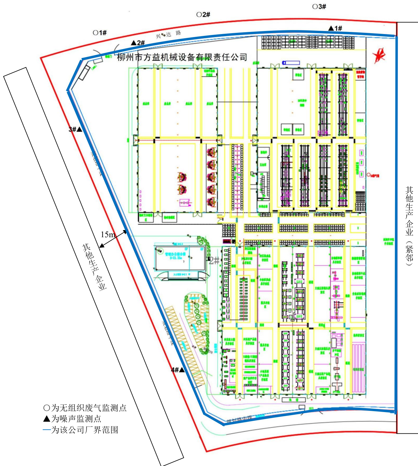
附图 2 项目平面图及监测点位
